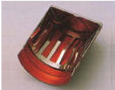
In **alluminio anodizzato** con molla radiale interna in acciaio inox. Per la chiusura sterile di provette e matracci per batteriologia. La speciale conformazione della molla radiale in acciaio inox, assicura una maggiore presa sul collo delle provette. Possono essere sterilizzati in autoclave o in stufa. Sono una alternativa al cotone e sono riutilizzabili
