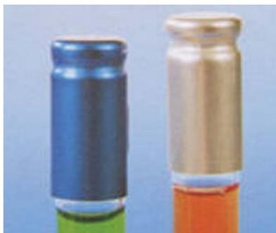
In alluminio anodizzato con molla incrociata interna in acciaio inox. **Per la chiusura sterile di provette e matracci** per batteriologia. La speciale conformazione della molla in acciaio inox, assicura una sicura tenuta. Possono essere sterilizzati in autoclave o in stufa. Sono una alternativa al cotone e sono riutilizzabili.
