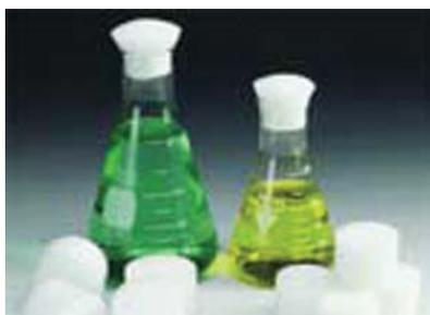
Per provette e matracci, si possono comprimere per essere comodamente inserite nel collo dei recipienti; quando si rimuovono, ritornano alla forma originale. Riutilizzabili e sterilizzabili, sia in autoclave che chimicamente.
