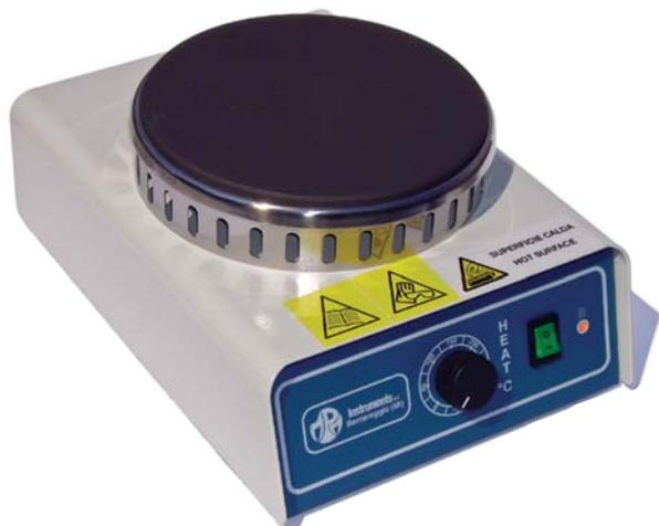
Riscaldatore di ridotte dimensioni per applicazioni termostatiche su campioni o reagenti in bicchieri. Struttura esterna in acciaio, trattata con vernice epossidica anticorrosione. Piastra riscaldante in ghisa con distribuzione uniforme di calore. Controllo della temperatura tramite termostato analogico. Costruito secondo le norme CEI (66-5). Marchio CE.
