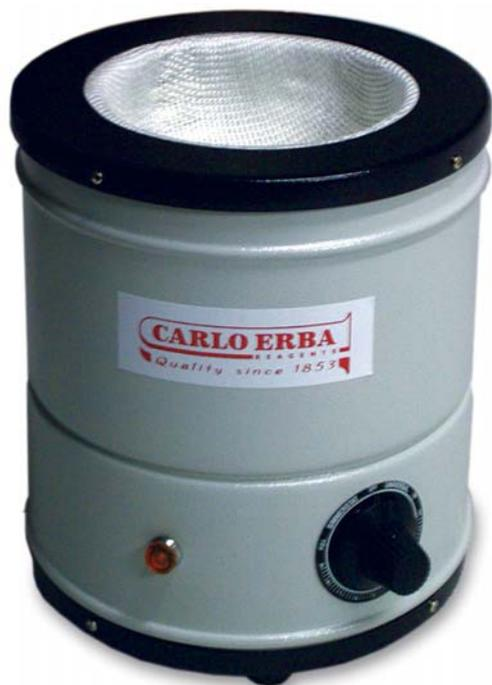
**Riscaldatori per palloni a un posto.** Involucro cilindrico in spessa lamiera d'acciaio inox verniciato, resistente ai più comuni aggressivi chimici. Resistenza interna in filo di nichel cromo rivestita di steatite al fine di ottenere un elevato isolamento elettrico. L'ottimo isolamento termico interno è assicurato dal rivestimento in fibra di vetro e lana minerale di roccia.
