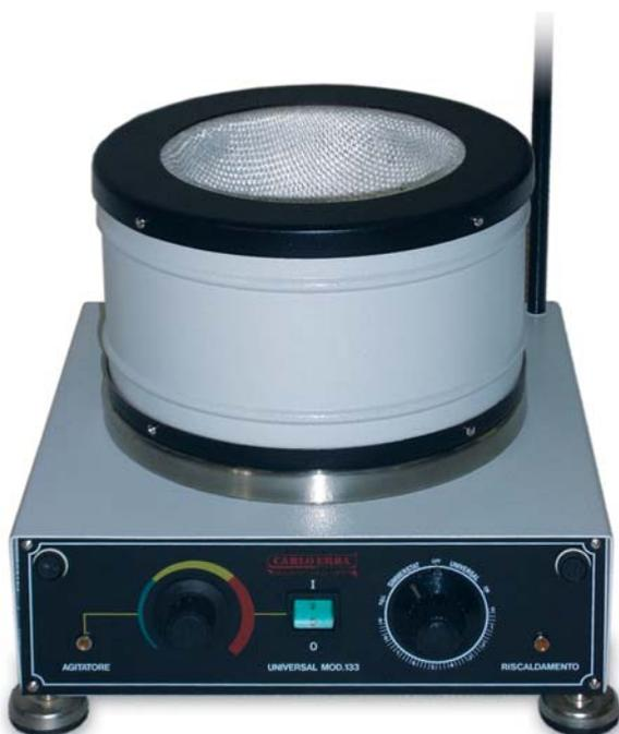
**Riscaldatori per palloni a fondo sferico** dove necessita l'agitazione interna del prodotto da riscaldare. Nel cilindro superiore trova alloggio il pallone con la parte riscaldante e l'isolamento termico. Nella base portante sono posizionati i comandi elettrici composti da un variatore elettrico che regola la velocità di agitazione, due fusibili, due spie luminose ed il comando della temperatura. Completo di asta di supporto.
