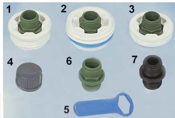
Il modello fornito è costituito da due raccordi: il bianco si fissa sul fusto, il verde, con entrambi i filetti da 3/4" si avvitano da una estremità sul bianco mentre dall'altra si applica il rubinetto o il tappo di chiusura. I diversi colori facilitano la scelta ed aiutano a meglio identificare il tipo di raccordo utilizzato. La chiave serve per fissare o rimuovere il raccordo a forma esagonale.
