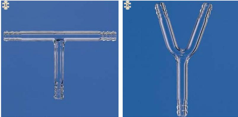
Raccordo di giunzione in vetro borosilicato con estremità coniche e rastremate per facilitare l'attacco dei tubi.
