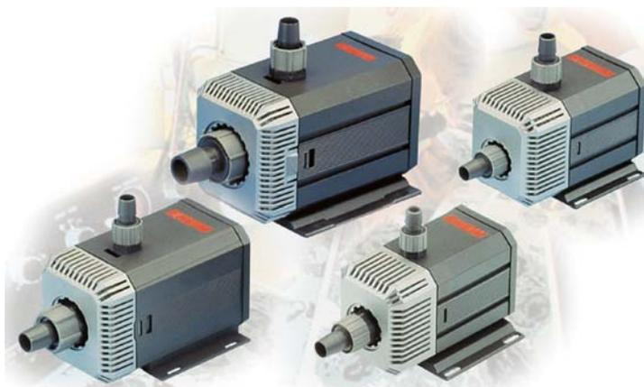
Inoltre per l'elevatissimo grado di protezione del motore (IP67), ottenuto annegando tutte le parti elettriche in un blocco di resina non conduttibile, queste pompe possono lavorare completamente immerse nel liquido da pompare.
