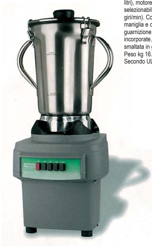
Omogeneizzatore di elevata capacità (4 litri), motore da 1700 W e tre velocità selezionabili (15.500, 18.300 e 22.000 giri/min). Contenitore in acciaio inox con maniglia e coperchio a tenuta con guarnizione e due molle di fissaggio. Lame incorporate. Basamento in lega di zinco smaltata in grigio. Altezza totale mm 580. Peso kg 16. Alimentazione 220/240V-50Hz. Secondo UL-USA, CE.
