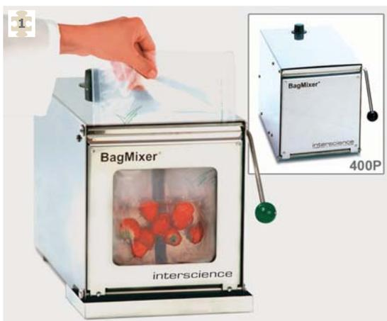
**BagMixer400**, è un omogeneizzatore da laboratorio a sacchetti sterili, che permette l'estrazione facile e sicura dei batteri dai campioni solidi. Struttura e camera di omogeneizzazione in acciaio inox. Omogeneizza efficacemente in un minuto un campione solido dentro un robusto sacchetto filtrante sterile. Dotato di temporizzatore regolabile. Preserva le cellule per una migliore analisi microbiologica.
