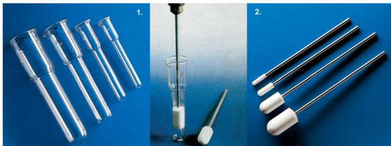
Per la preparazione di omogenati di tessuti e materiale biologico. Provetta in vetro borosilicato e pestello in PTFE con asta in acciaio (Ø mm 6,5) collegabile ad un agitatore tramite mandrino. Il pestello si adatta perfettamente alla provetta lasciando un interstizio di mm 0,15-0,25.
