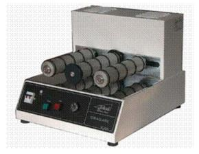
Per la rotazione costante di 2 giare con volumi fino a 5 litri. Struttura portante in lamiera di acciaio con verniciatura antiacida in resina epossidica. Gruppo di movimento e motoriduttore di potenza. Quadro comandi provvisto di interruttore magnetotermico di sicurezza, pulsanti luminosi di START e STOP, timer elettronico con programmatore 0-12 ore.
