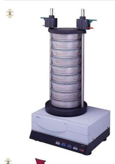
I setacciatori analitici Retsch vengono usati nei laboratori di ricerca e sviluppo, controllo qualità di materiali grezzi o finiti ed anche in produzione. Le tre serie dell'AS 200 consentono di selezionare lo strumento a seconda dei propri requisiti per controlli analitici. Con la serie AS 200 è possibile setacciare anche con acqua ("setacciatura bagnata").
