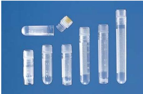
Provette per criogenia indicate per la conservazione di materiale biologico: microrganismi, cellule umane o animali. In polipropilene graduate. Ampia area di scrittura e inserto colorato nel tappo per una facile identificazione. Termicamente stabili fino a -196 °C. Sterilizzate con radiazioni gamma (SAL 10-6), sterilizzabili in autoclave a 121°C per 20 minuti.
