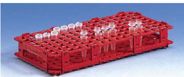
Realizzato in polipropilene ad alta densità per cui non galleggia se immerso nell'acqua.
