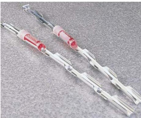
In alluminio per lo stoccaggio di Cryovials da ml 1,2 a 2,0 nei contenitori per azoto liquido Biocane. Con fermi di tenuta per le singole vials. Possibilità d'inserimento di una targhetta "Color-Cane" e di una guaina di protezione "Cryosleeve".
