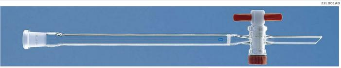
Pz/CF Lunghezza utile mm Ø interno mm Volume ml Cono superiore SN Codice 295056629 200 10 15 14/23 295056630 300 10 23 14/23 295056631 1 200 15 35 14/23 295056632 1 400 20 125 29/32 295056633 30 295056634 600 430 29/32
