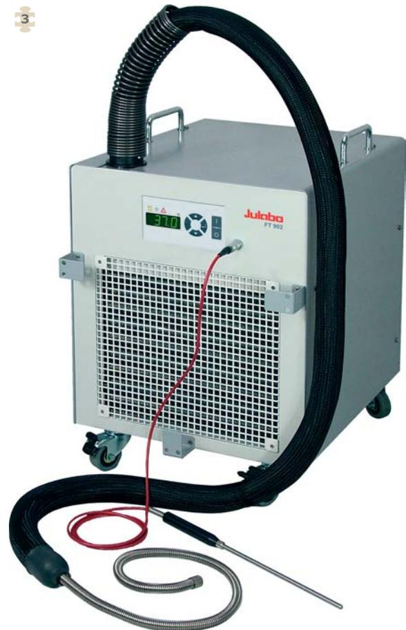
Ideali per la refrigerazione secondaria in termostati a vasca aperta in sostituzione dell'acqua di rete o in sostituzione del ghiaccio secco. Rapido raffreddamento di liquidi alle basse temperature ad es. in contenitori Dewar. I mod. FT402 e FT902 sono dotati di sonda PT100 (L 200 x Ø 6 mm in acciaio inossidabile), tastiera per l'impostazione della temperatura e display LED.
