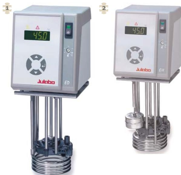
Adatti per vasche con volume fino a 50 litri. Dotati di morsetto per fissaggio a pareti con spessore fino a 26 mm. Profondità di immersione min/max 80 - 165 mm. Controllo temperatura PID.
