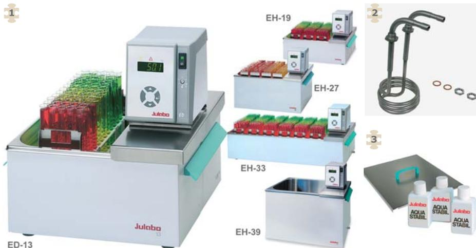
Ideali per la termostatazione di oggetti direttamente all'interno della vasca. I mod. EH-19, EH-27, EH-33 ed EH-39 possono essere utilizzati per la termostatazione di circuiti esterni chiusi, in quanto sono dotati di connettori per la pompa di circolazione. Per i rimanenti modelli è possibile utilizzare il set pompa opzionale.
