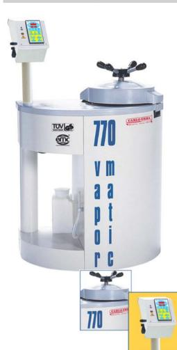
Autoclave per sterilizzazione a caricamento verticale, con ciclo di sterilizzazione completamente automatico, termoregolato e controllato da microprocessore. Ideale per laboratori di media grandezza.
