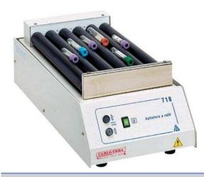
Particolarmente indicato per mantenere in idonea agitazione provette con sangue intindagini ematologiche. Costruzione esterna in acciaio con verniciatura in polvere, dot PVC antiscivolo Ø 30 mm. Velocità dei rulli 60 giri/minuto e 45 oscillazioni al minuto, di 28 mm.
