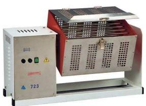
Dotato di cestello a celle separate adatto per contenere 18 sacche piastrine da 400 ml. costante (5 giri/min.) consente di mantenere in continua sospensione il materiale cellula della trasfusione. Dotato di cestello forato a 9 scomparti che permette la circolazione de evitare variazioni di temperatura. Il motore è disposto in posizione tale da garantire un I continuo per molte ore senza rischio di surriscaldamento. Costruzione esterna in acciaio verniciatura in polvere, cestello in acciaio inox.
