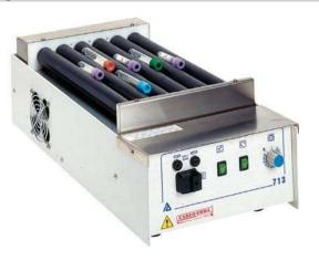
Adatto per provette e flaconi di varie dimensioni, dotato di un duplice movimento rotoscillatorio. L'apparecchio è provvisto di 6 rulli in PVC antiscivolo Ø 30 mm. Velocità 6 e 12 oscillazioni al minuto con ampiezza di 32 mm. Pannello frontale dotato di seletto funzionamento in continuo o prefissato mediante timer fino a 60' ed interuttore per forotativo e/o oscillatorio. Costruzione esterna in acciaio con verniciatura in polvere.
